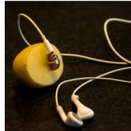
**So geht's:** Halbiere die Kartoffel und stecke in die Schnittfläche den Zinknagel und die Centmünze so nah beieinander, dass der Stecker des Kopfhörers beide berührt, wenn du ihn dazwischen legst. Setz den Kopfhörer auf. Hörst du es knistern? Das ist Strom, der aufgrund der chemischen Reaktion der beiden Metalle und des Kartoffelsaftes entsteht.
